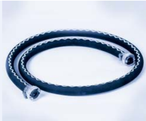
Tubo de conexión con embragues D incluidos, a prueba de agua caliente hasta 100° C, a prueba de presión hasta 20 bar, 2,5 ó 5 m, acoplamiento posible.
