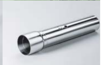
Tubo nebulizador de alto rendimiento para mezclas de preparación química a base de agua (accesorios especiales). Con este tubo se alcanza con la atomización de preparaciones acuosas un espectro de gotitas casi igual de las mezclas con neblina de aceite.
