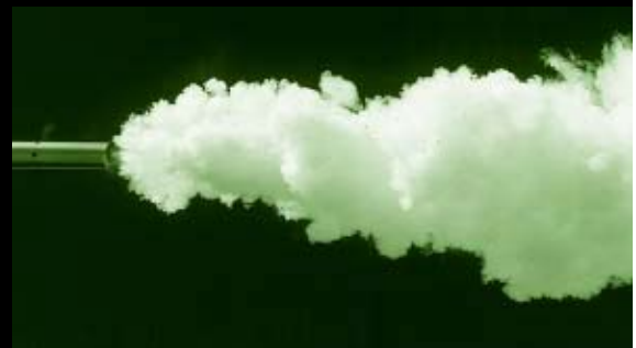
Tubo nebulizador de alto rendimiento para mezclas de preparación química a base de agua (accesorios especiales). Con este tubo se alcanza con la atomización de preparaciones acuosas un espectro de gotitas casi igual de las mezclas con neblina de aceite.
